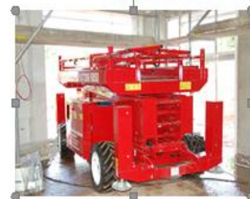
Schere mit abgeklapptem Geländer (Höhe 1,92)
