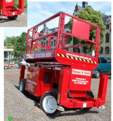
Schere mit abgeklapptem Geländer (Höhe 1,92)
