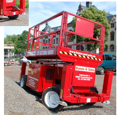
Schere mit abgeklapptem Geländer (Höhe 1,92)
