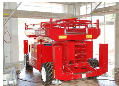
Schere mit abgeklapptem Geländer (Höhe 1,92)
